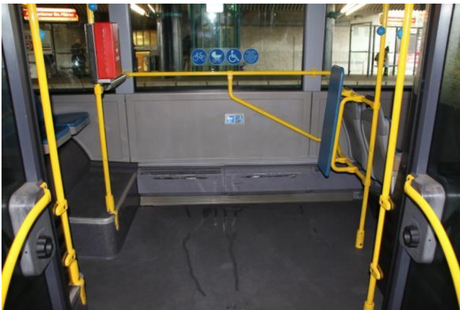
Bild 20: Beispiel für einen kleinen Mehrzweckbereich (annähernd Mindestmaße gem. UN/ECE Regelung Nr. 107, Lage gegenüber der hinteren Tür)
