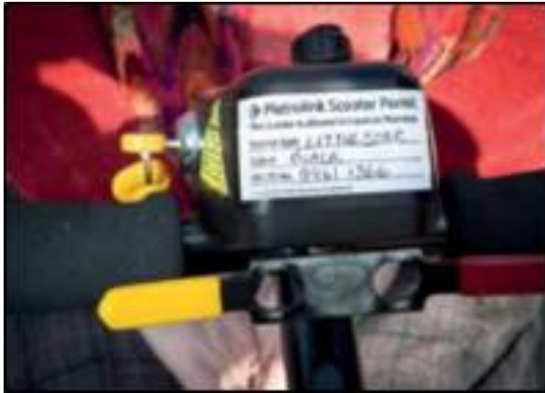
Bild 12: Kennzeichnung eines für die Beförderung im ÖPNV zugelassenen Elektromobils mittels Ausweis an der Lenksäule (Quelle: MetroLink)
