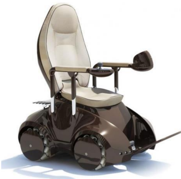
Bild 47: Omnichair – omnidirektional steuerbarer Elektrorollstuhl [102]
