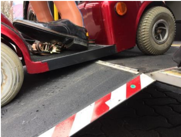
Bild 29: Rampenüberfahrt bei Einstieg von Fahrbahnniveau (Bus einseitig abgesenkt)
