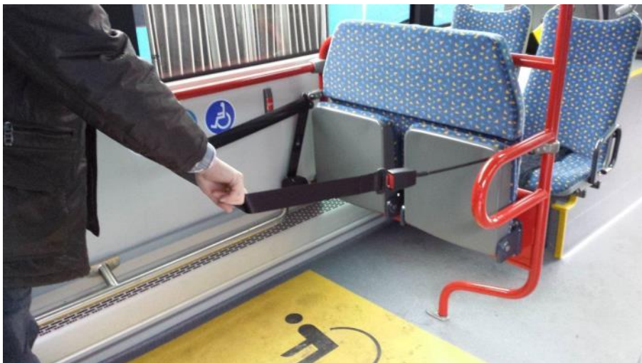
Bild 41: Zusätzliches Gurtsystem zur Sicherung von Elektromobilen am Rollstuhlstellplatz – Beispiel Kassel (Foto: KVG/Wiesenhütter)
