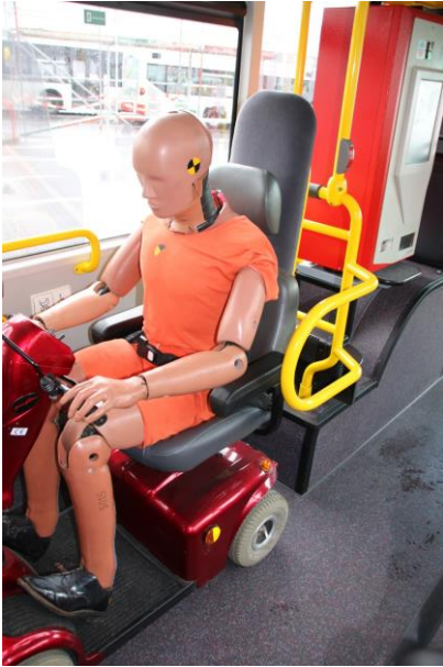
Bild 38: In einem Linienbus entgegen der Fahrtrichtung aufgestelltes Elektromobil an einem Rollstuhlstellplatz mit Rückhalte- und Sicherheitseinrichtungen gemäß UN/ECE Regelung Nr. 107 [12]
