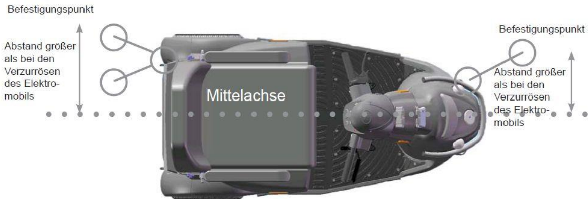
Bild 34: Beispiel für Hinweise auf die für eine Verankerung am Fahrzeugboden geeigneten Befestigungspunkte an einem Elektromobil Typ Minicrosser 2 (Quelle: MedemaGroup)
