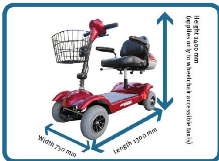
Bild 15: Maximal zulässige Abmessungen für Elektromobile für den Transport im ÖPNV in Queensland (Australien) [81]
