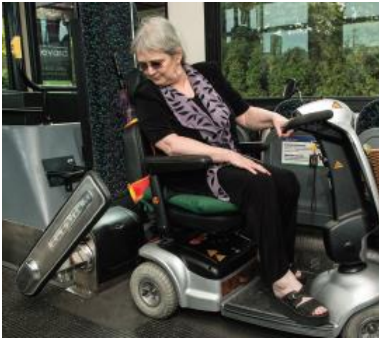
Bild 43: Automatisiertes Sicherungssystem für Rollstühle und Elektromobile (hier Sicherung eines Elektromobils) [100]
