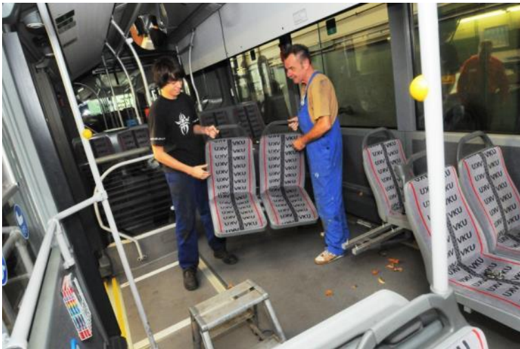
Bild 32: Ausbau von Sitzreihen in einem Bus zur Vergrößerung des Mehrzweckbereichs – Beispiel Verkehrsgesellschaft Kreis Unna (Foto: Westfälische Rundschau/WAZ)
