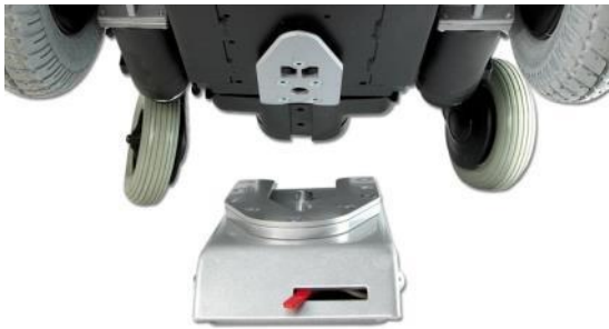
Bild 46: Verriegelungsplatte am Rollstuhl und Docking-Station (Quelle: Dahl Engineering)
