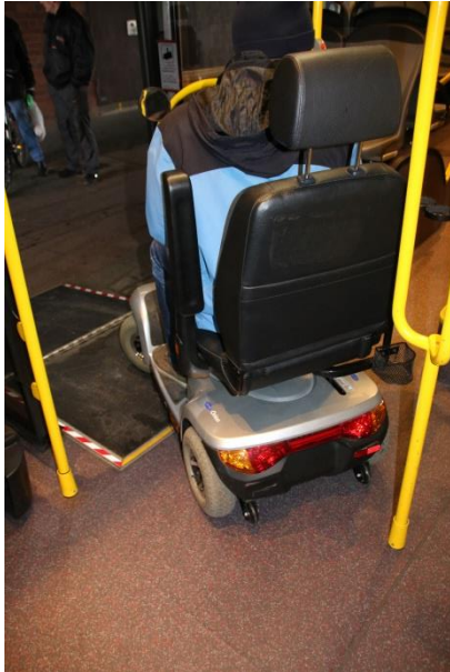
Bild 26: Behinderung der rückwärts gerichteten Rangierfahrt durch eine senkrechte Haltestange im Bereich der zweiten Tür eines Linienbusses
